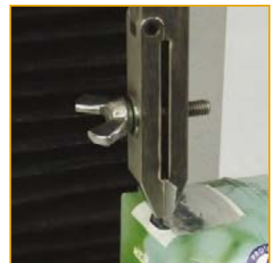
Ensayo de pelado en lámina de aluminio sellado por inducción
