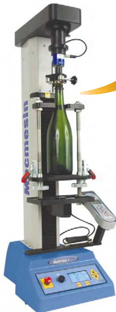
Ensayo de la fuerza de extracción de tapones de corcho natural y sintético
