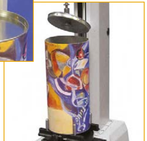
Ensayo de extracción de tapa
