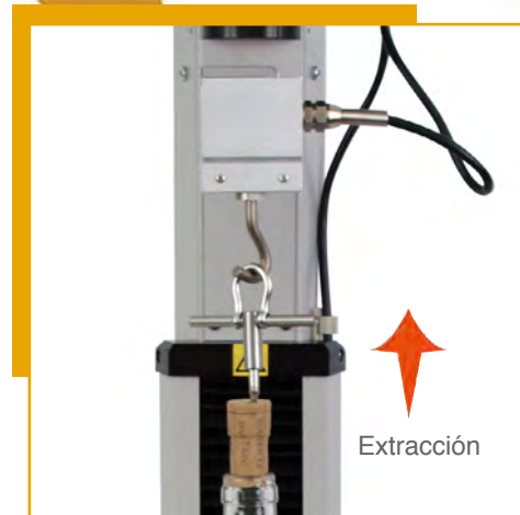
Sistema configurado para ensayos de tapones de corcho en vinos tranquilos
