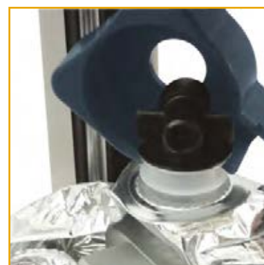
Fuerza a tracción de junta sellada
