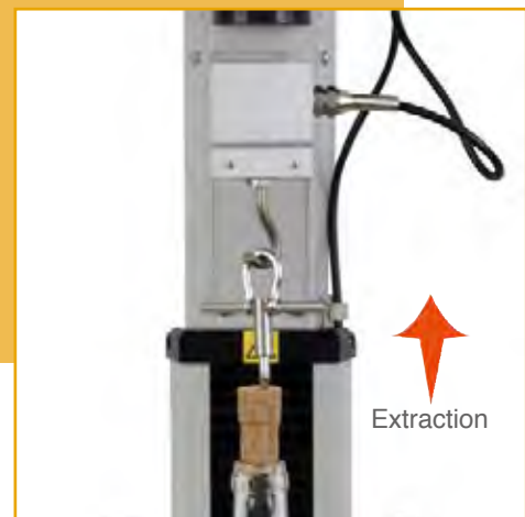
Système adapté à l'extraction verticale pour vins tranquilles
