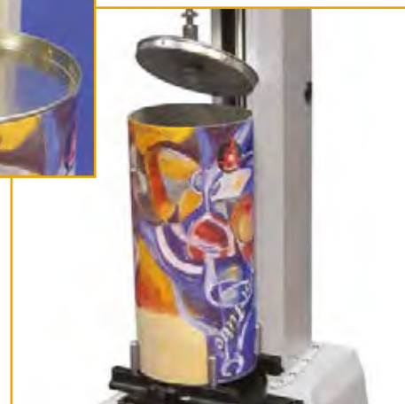
Test de soulèvement de couvercle
