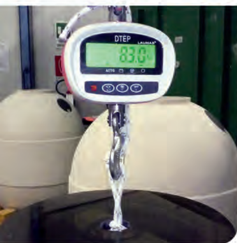
Prova di tenuta Lid pull test
